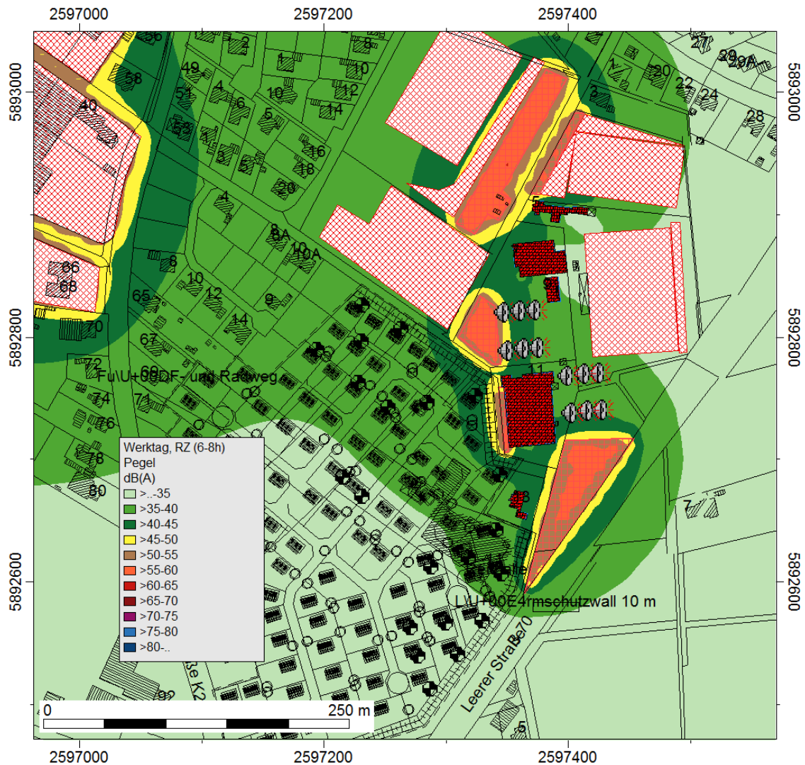
Abbildung 2: Rasterberechnung werktags von 6-8h (RZ). Bezugspunkt: 1. OG (4,80 m)
